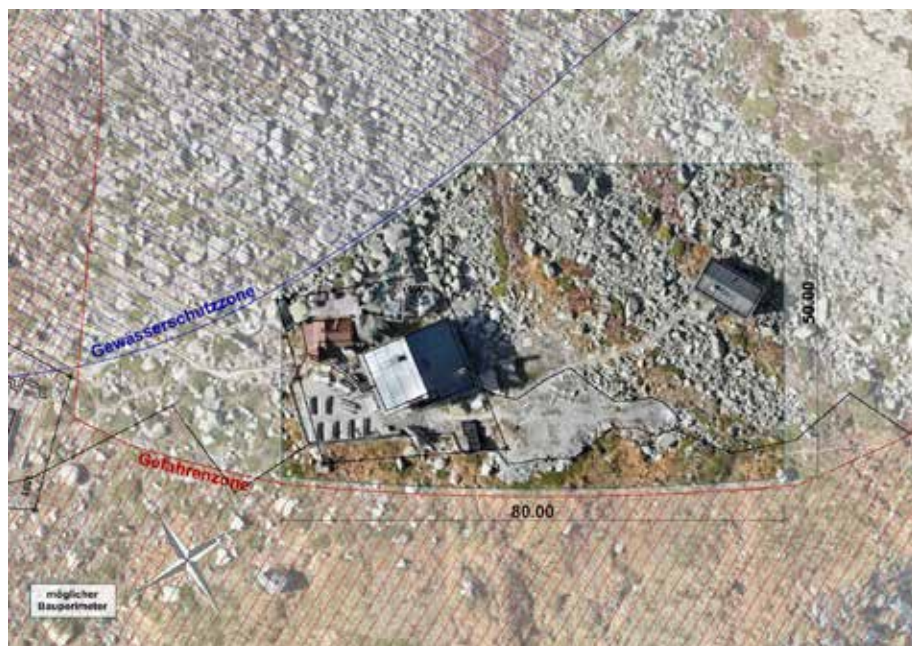
Bauperimeter mit Schutz-/Gefahrenzonen Chamanna da Boval
