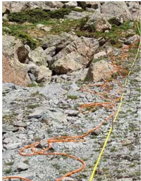
Alle 2 Meter kommt eine Sonde, welche mit dem Stromkabel verbunden wird.
