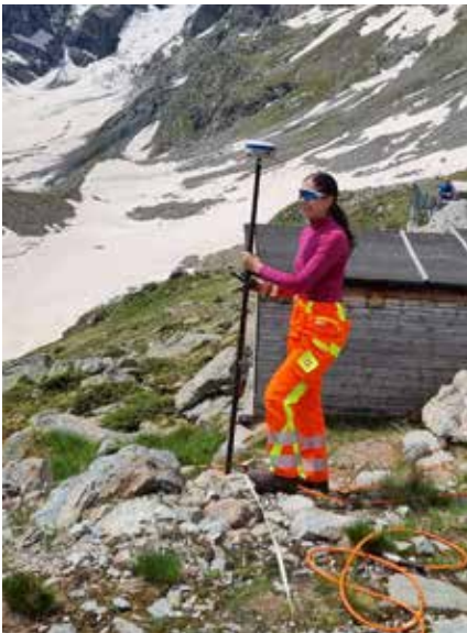
Standortbestimmung der Sonden mittels GPS
