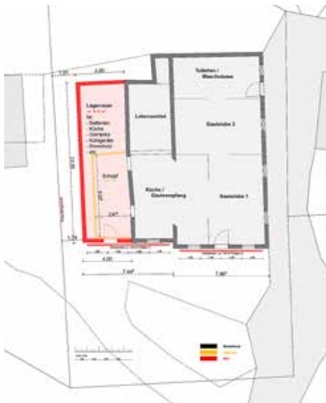
Grundriss Rifugio Saoseo "Bestehend mit neuem Anbau"
